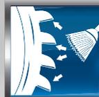
Bürstverfahren zum Verrunden der Schneidkanten, um deren Ausbrechen zu verhindern
